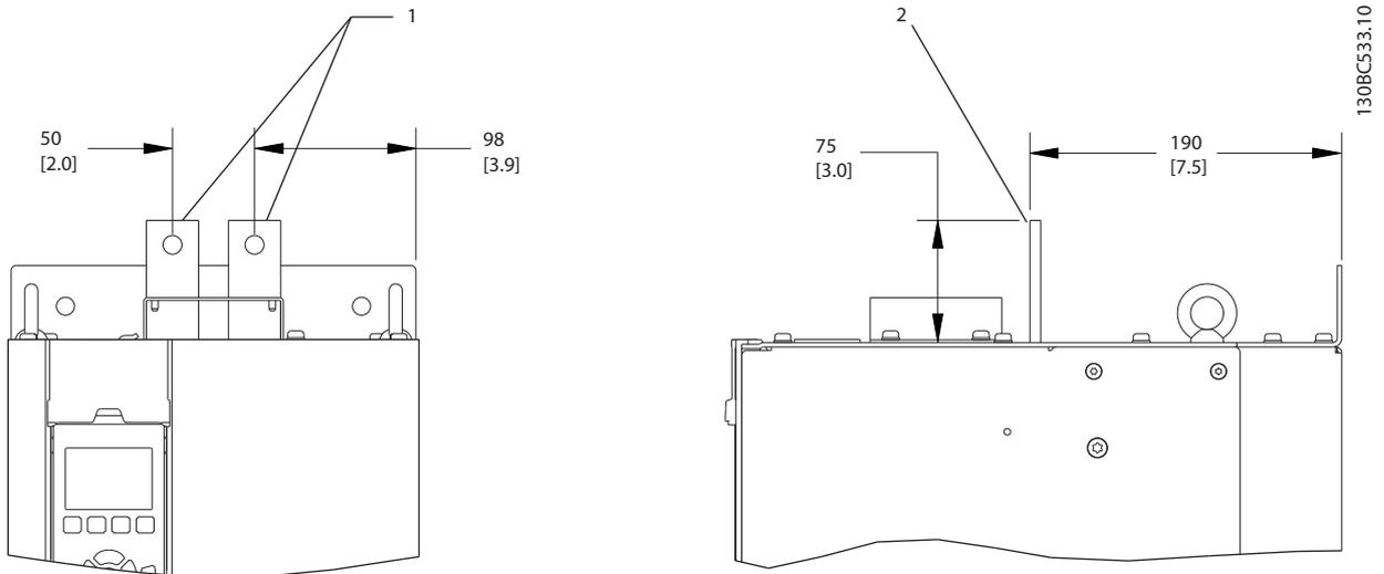
Рисунок 2.9 Клеммы цепи разделения нагрузки и рекуперации, D3h
