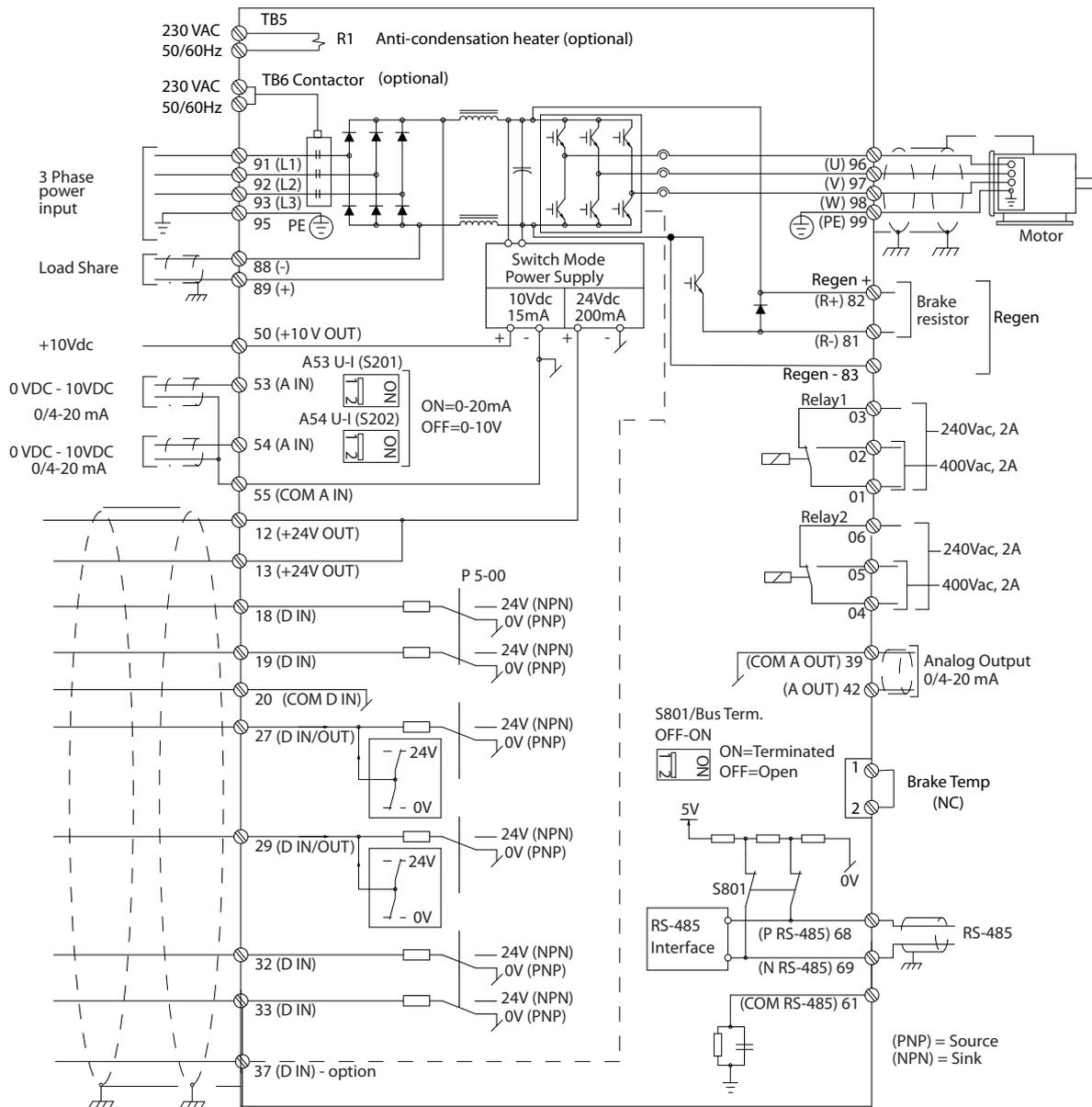
Рисунок 2.2 Схема межкомпонентных подключений
