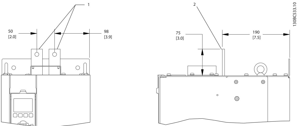
Рисунок 2.9 Клеммы цепи разделения нагрузки и рекуперации, D3h
