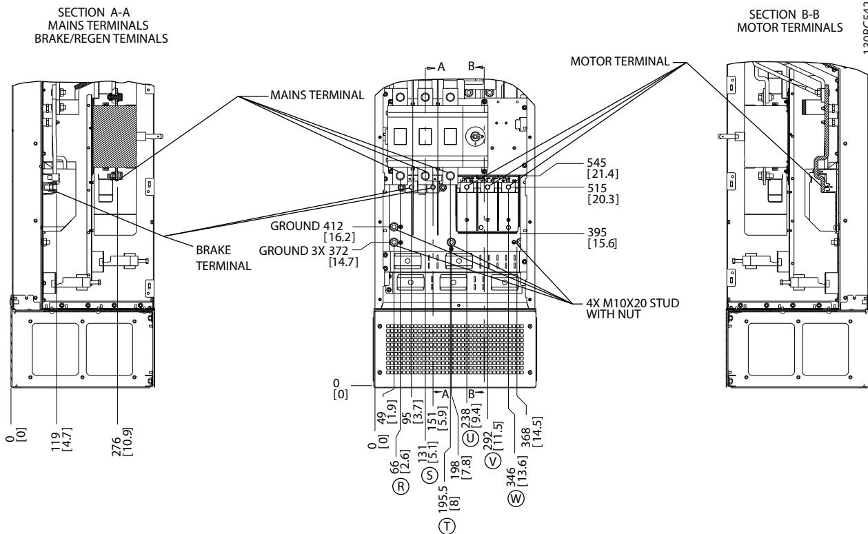
Рисунок 2.18 Расположения клемм, D7h с разъединителем
