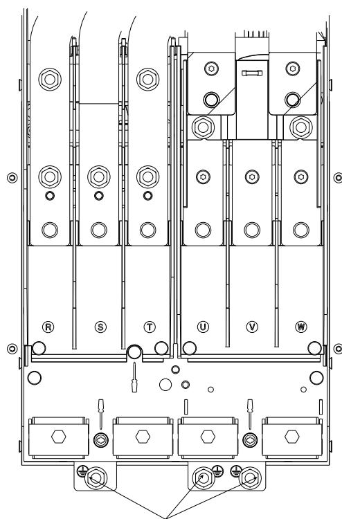
Рисунок 2.5 Точки заземления (зануления) для корпусов (шасси) IP20
