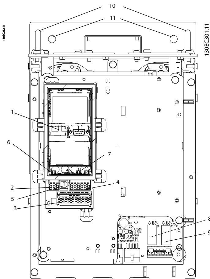
Рисунок 1.2 Крупный план: LCP и функции управления частотой
