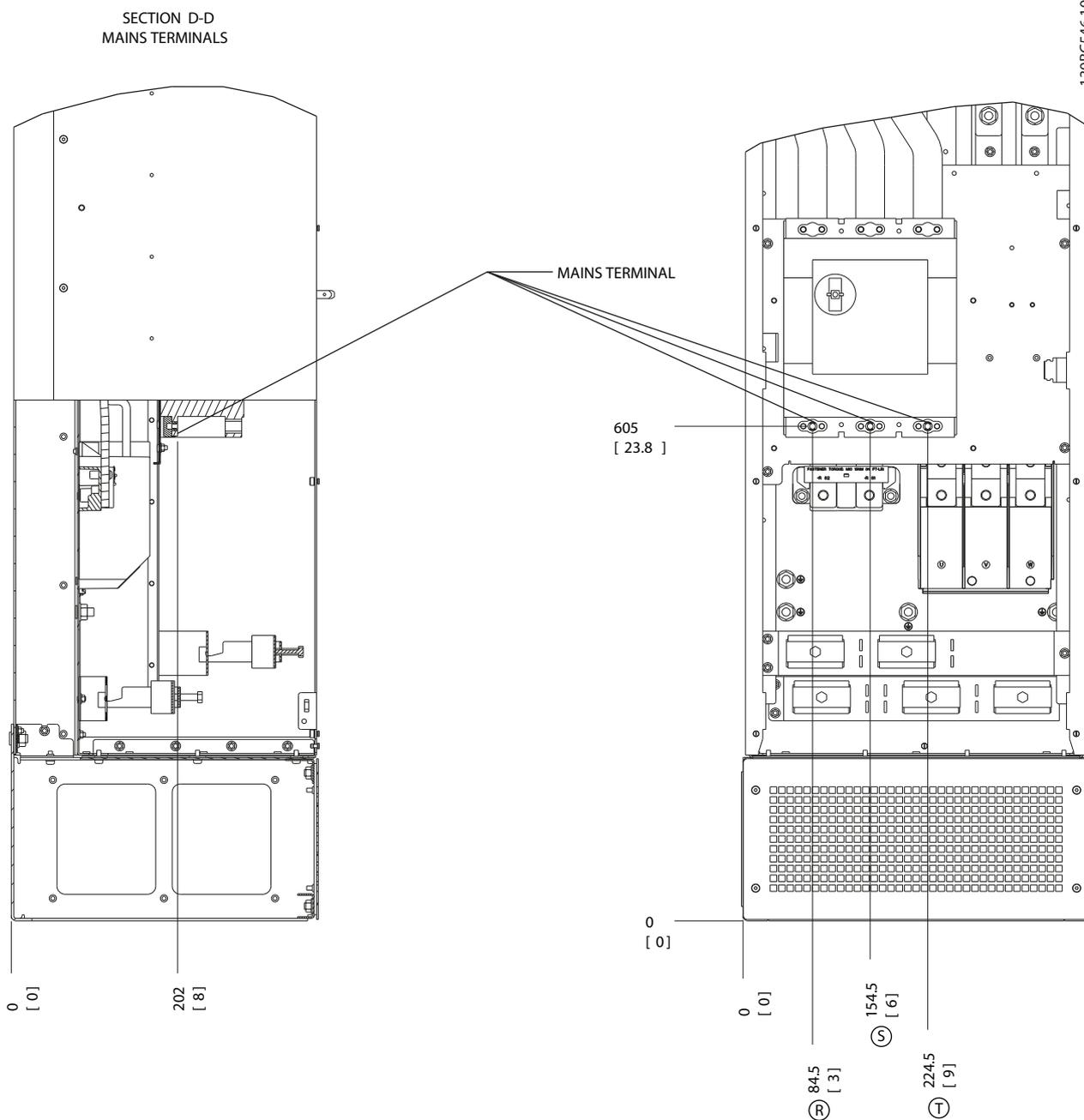
Рисунок 2.22 Расположение клемм, D8h с автоматическим выключателем
