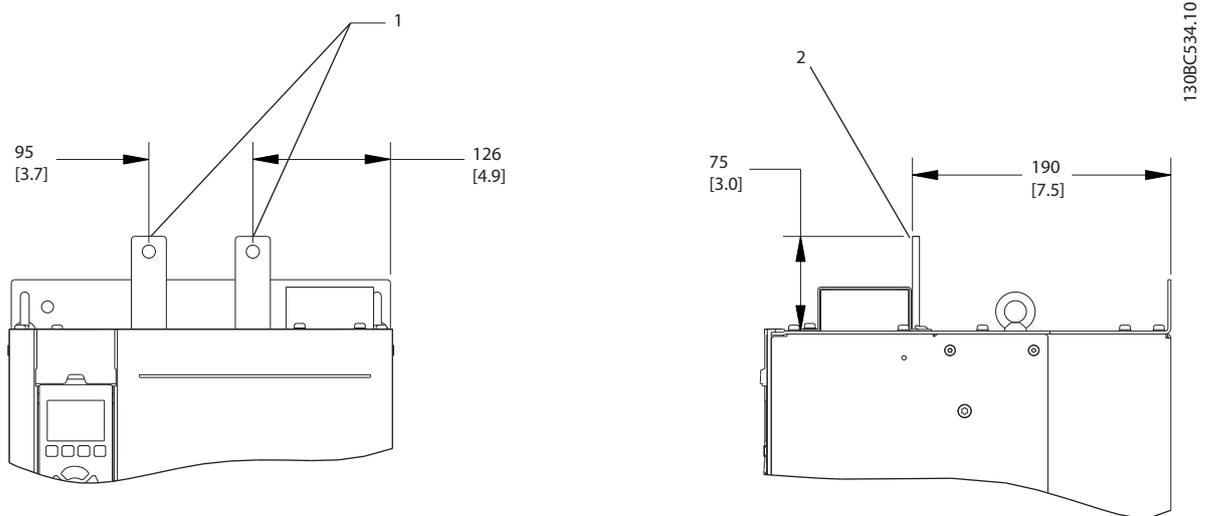
Рисунок 2.12 Клеммы цепи разделения нагрузки и рекуперации, D4h
