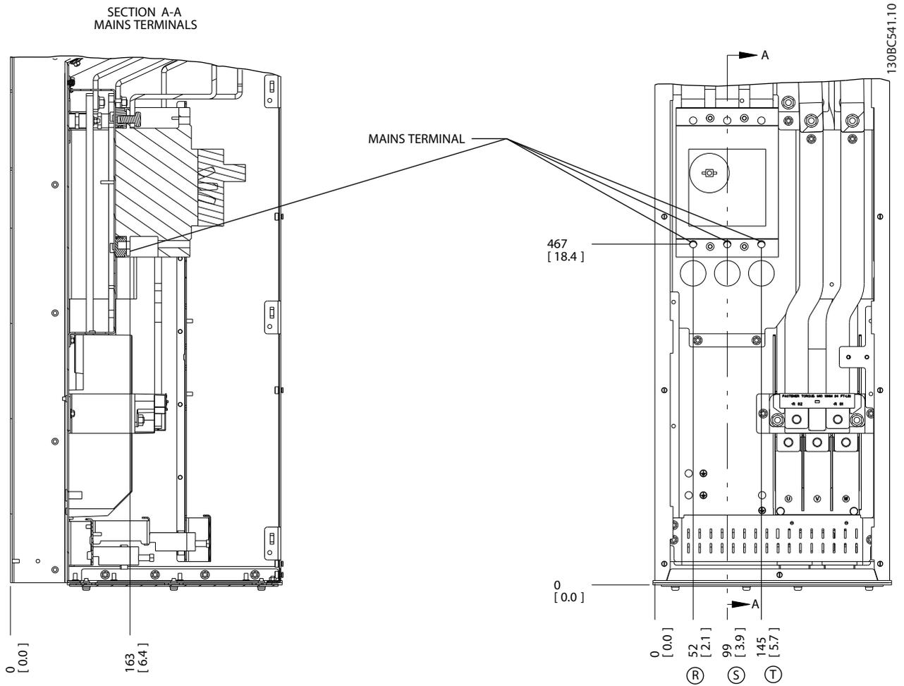
Рисунок 2.17 Расположение клемм, D6h с автоматическим выключателем
