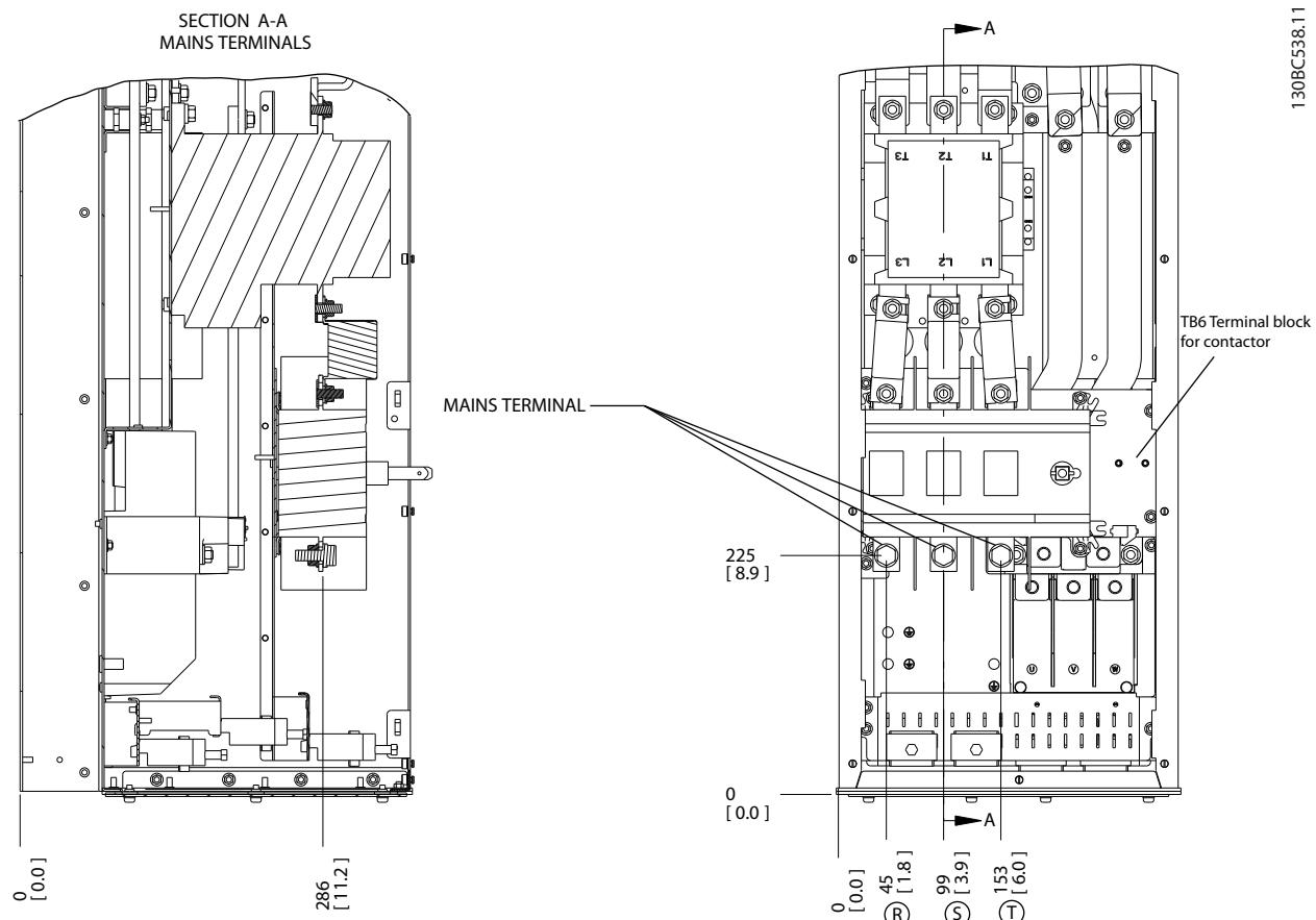
Рисунок 2.16 Расположение клемм, D6h с контактором и разъединителем
