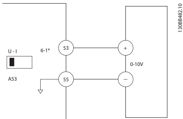
Рисунок 5.10 Пример подключения к внешнему устройству с управляемым сигналом 0–10 В
