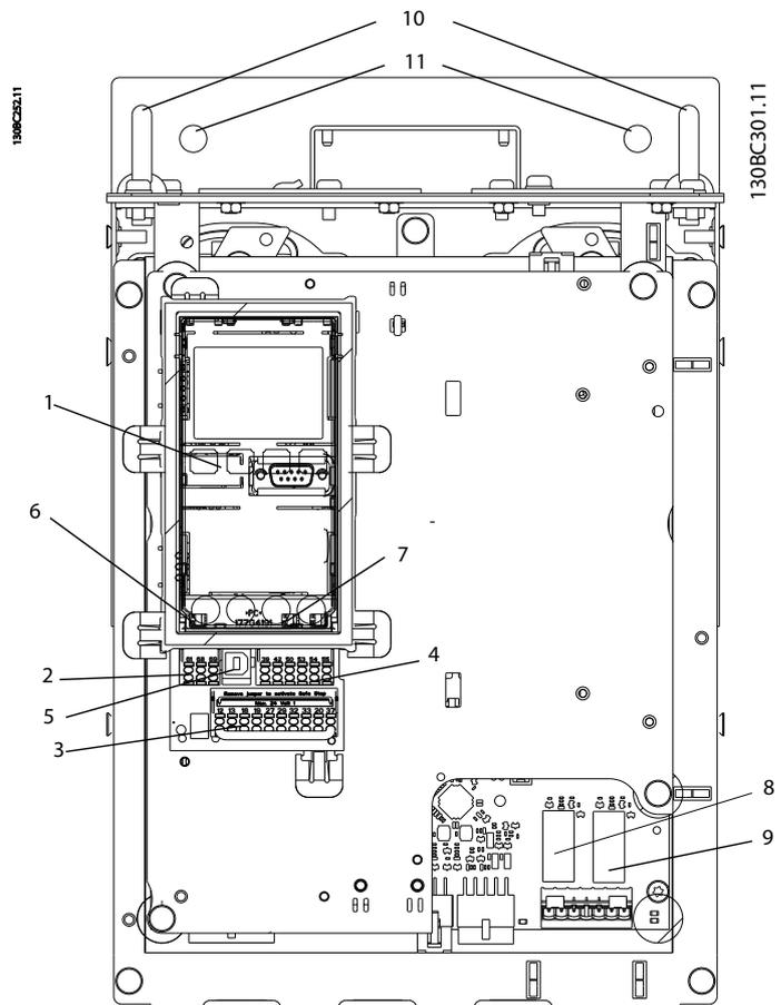
Рисунок 1.2 Крупный план: LCP и функции управления частотой
