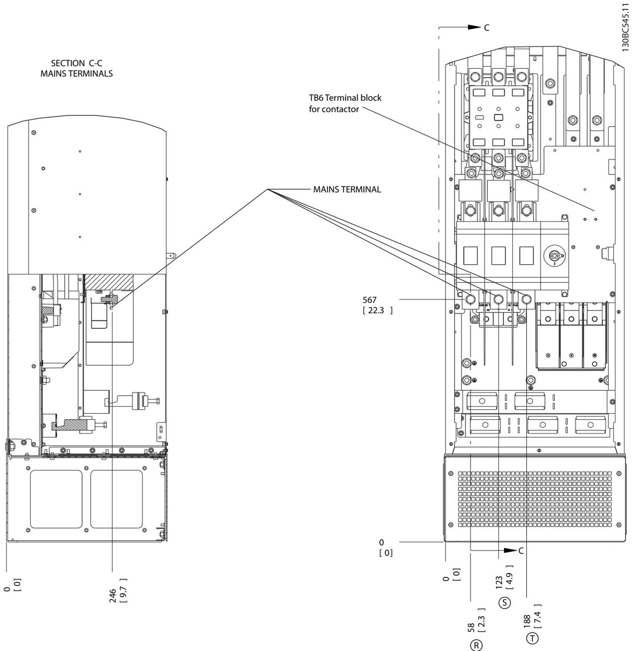
Рисунок 2.21 Расположение клемм, D8h с контактором и разъединителем
