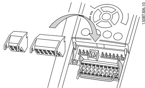
Рисунок 2.30 Удаление клемм управления
