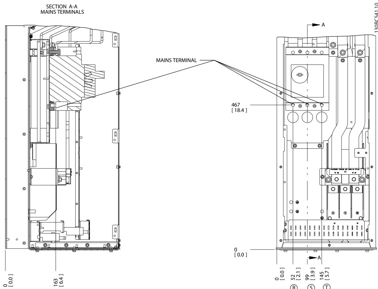
Рисунок 2.17 Расположение клемм, D6h с автоматическим выключателем
