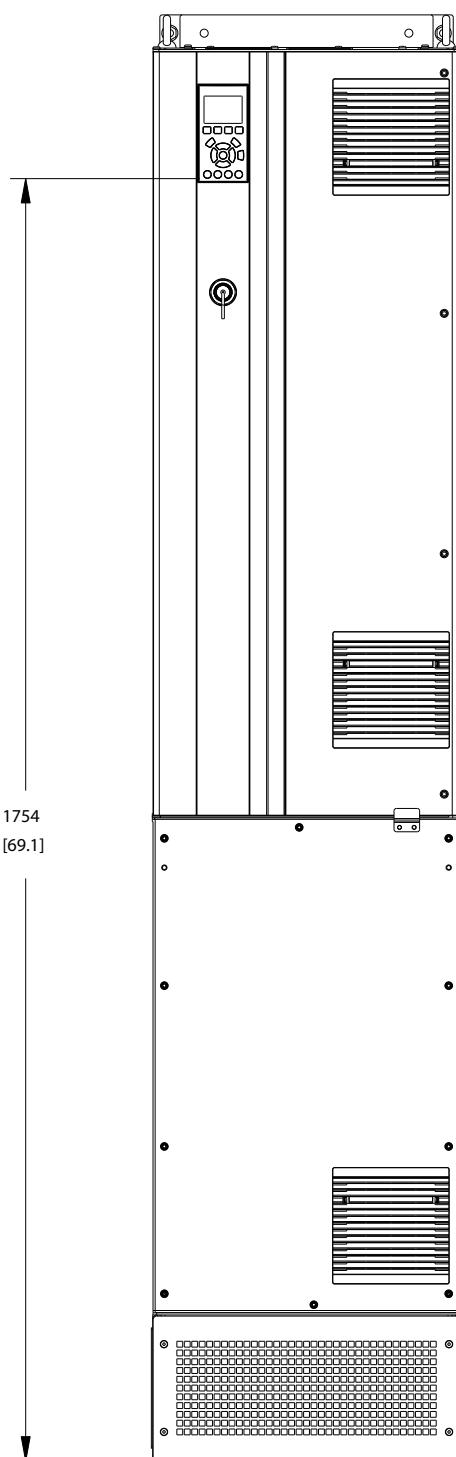
Рисунок 1.3 Корпус D7h
