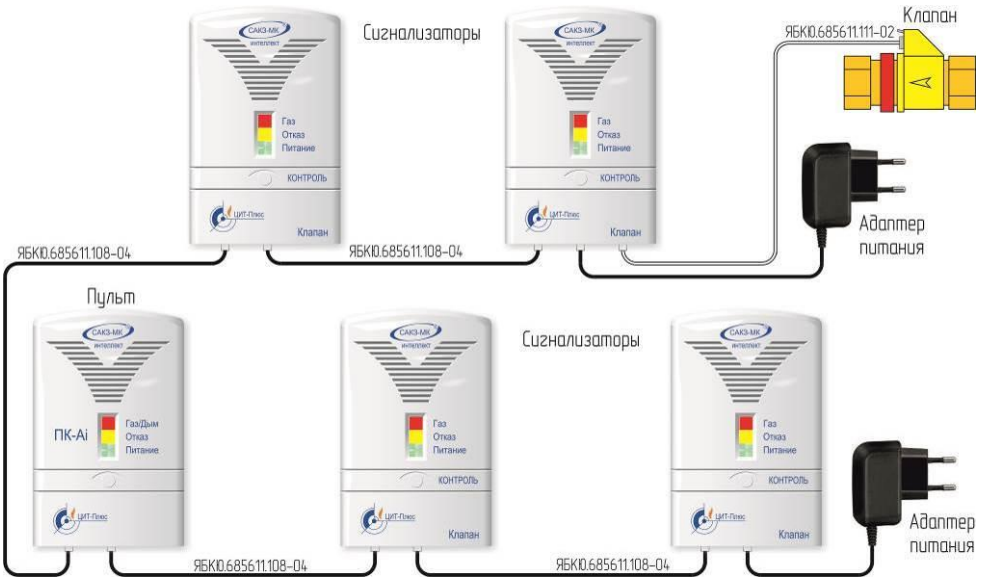
Рисунок Б.2 – Схема соединений с дополнительными сигнализаторами
