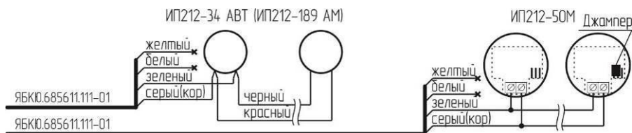
Рисунок Б.3 – Система с пожарными извещателями
