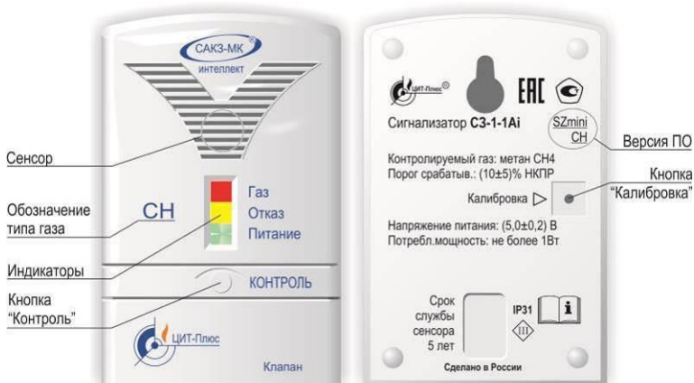
Рисунок 1 – Внешний вид сигнализатора
