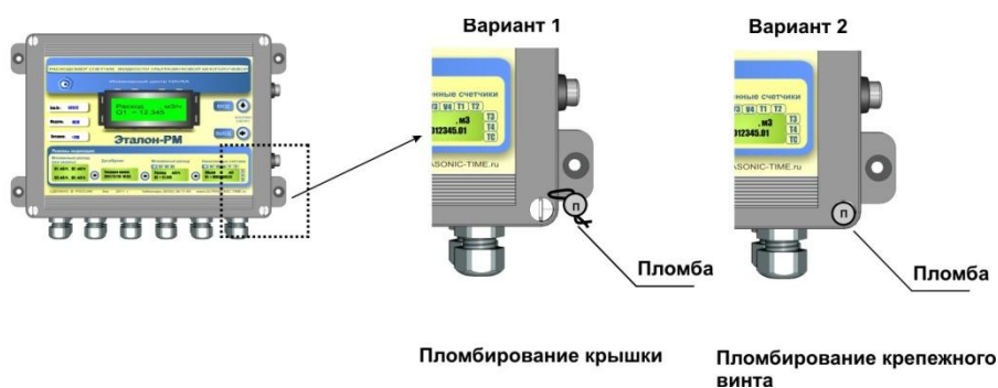
Рисунок 7 – Варианты пломбирования ЭБ
